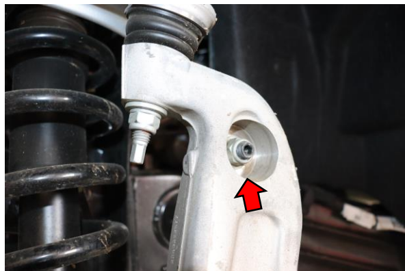
2. Remove 18mm sway bar end link nut.
