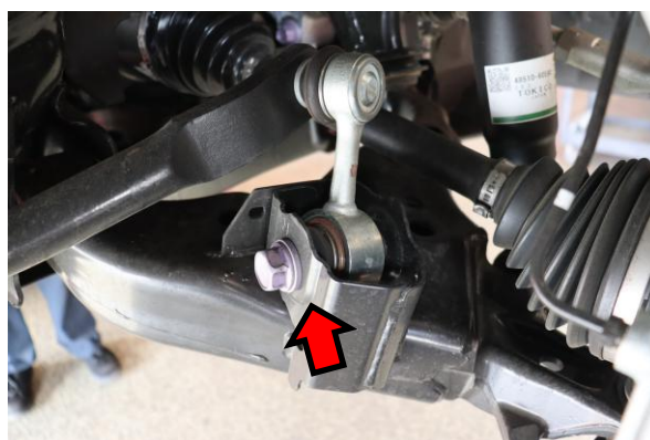
4. Remove the sway bar end link bolt.
